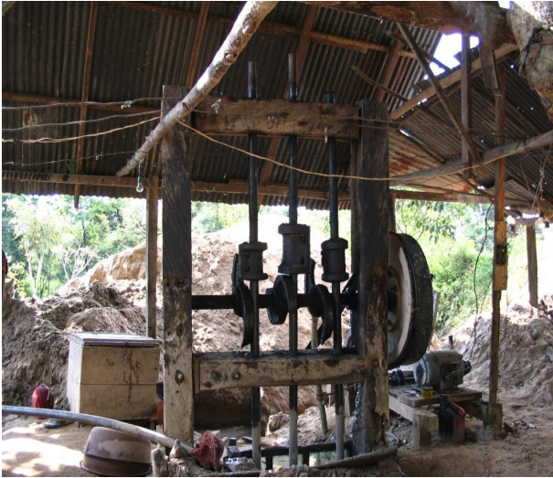
Molinos californianos empleados en la trituration del material
